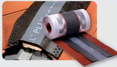
Material: **Faldas laterales de aluminio moldeable y deformable hasta un 50%, tiene en su zona central de polipropileno hidrófugo con un doble canal de ventilación y un sistema de aperturas geométricas para una ventilación (150 cm²/ml) optimizada y una protección total contra los elementos exteriores.**
