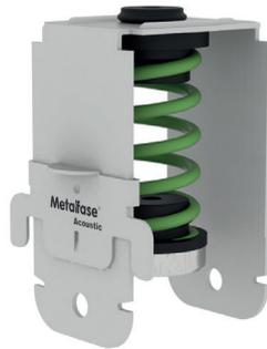
Soporte antivibratorio, para la construcción de techos acústicos. Frecuencia de resonancia 3,5 - 5 Hz.
