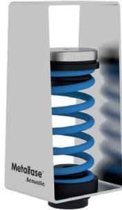
Soporte antivibratorio, para la construcción de techos acústicos o soportación de máquinas con régimen de trabajo por encima de 900r.p.m. Frecuencia de resonancia 3,5 - 5 HZ.
